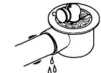
排水接続部の取り付けに不備があると、排水時に接続部より水漏れする原因になります。
